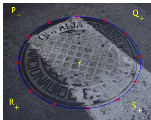
(b) Medición de 12 puntos sobre el objeto a rectificar
